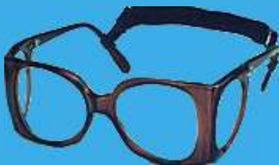
RSB 8/Pb (85 g) Röntgenschutzbrille: mit PVC-Rahmen und zusätzlichem Seitenschutz mit Halteband. Bleiwert Front 0,75 mm Pb, seitlich mindestens 0,50 Pb. Bestellnummer: 858008
